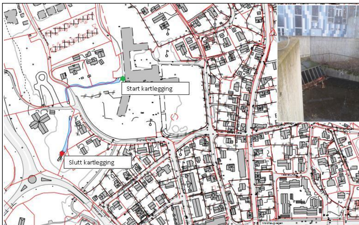
Bilde: Kartlagt strekning, bekken går i rør fra Skienselva og til oppstrømsside av Vestsida Skole
