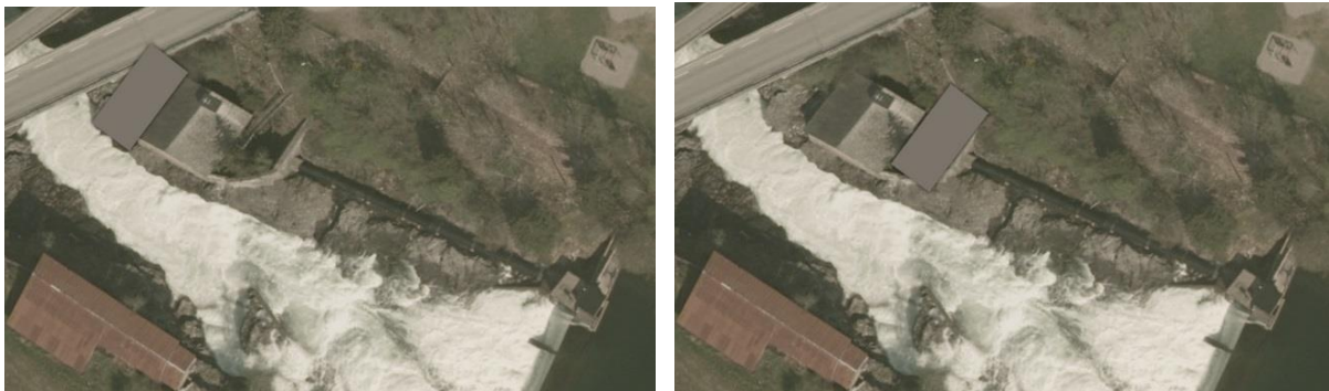
Figur 7 viser at en plassering av ny kraftstasjon vest for eksisterende kommer i konflikt med brua langs fv. 307. Om man velger å beholde eksisterende kraftstasjon må nytt bygg i tilfelle legges til kraftstasjonens østside. Dette vil gi et nytt stort bygg tett på det gamle, noe som er utfordrende både under bygging og i forhold til det å få til en god helhet. I tillegg vil man sitte igjen med et langt større bygningsvolum enn man har behov for.
