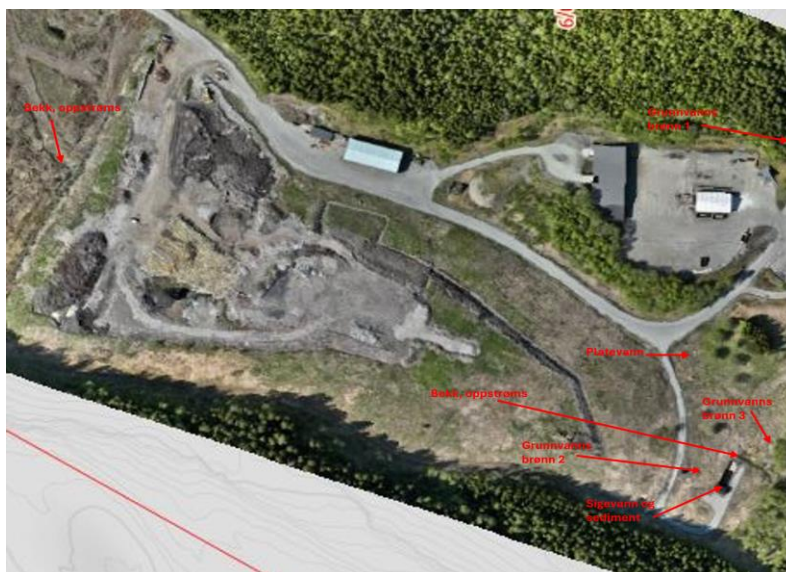
Bilde 7: Oversikt over hvor prøvepunktene for sige vann, grunnvann og bekk ligger
